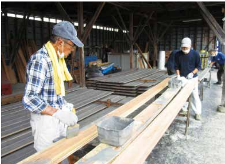
塗装作業 杉板に塗料を刷毛塗り
